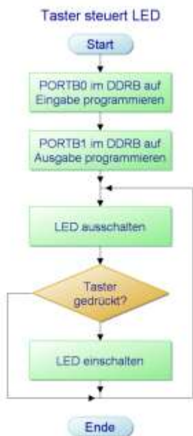
Abbildung 26: Tasterabfrage mit Hilfe des Skip-Befehls, der einen Befehl überspringen kann
