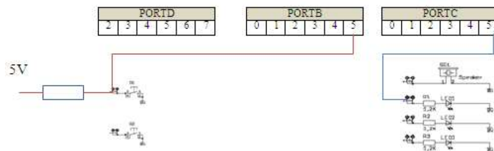
Abbildung 23: Der Anschlussplan des Tasters und der Leuchtdiode am AVR-Board. Der Pullup-Widerstand muss zusätzlich verdrahtet werden.
